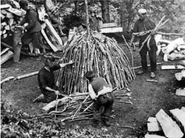
Una volta predisposto l'arale occorreva allestire il 'poiàt', la catasta di legna da trasformare in carbone. La legna forte, come faggio, rovere e carpino forniva il carbone migliore particolarmente adatto per i forni fusori, mentre per il funzionamento delle fucine di ferro andava bene anche il carbone prodotto con il legname di castagno o di nocciuolo.
